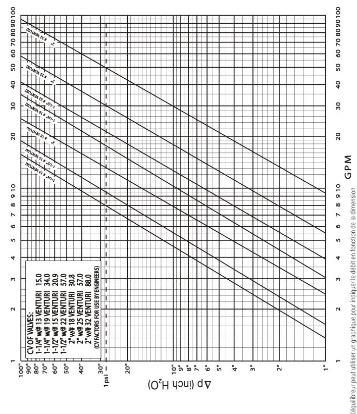
du venturi et de la pression différentielle (pouces H20).
