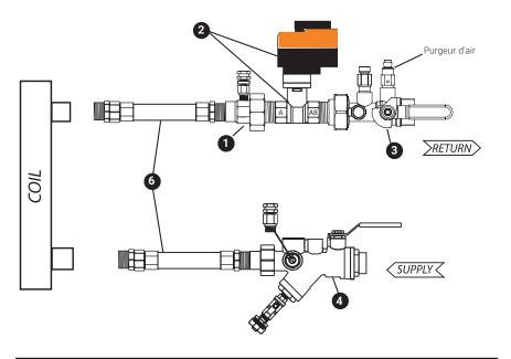
Robinet de réglage caractérisé à 3 voies (CCV)
